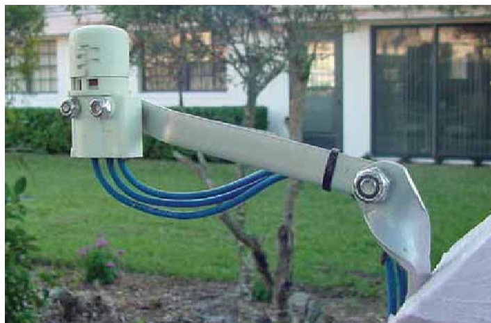
Sensores de lluvia.
