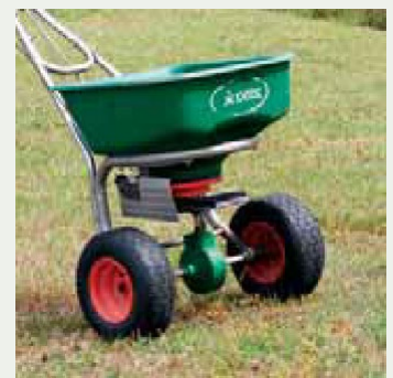
Un escudo deflector dirige el fertilizante lejos de su zona libre de mantenimiento.
